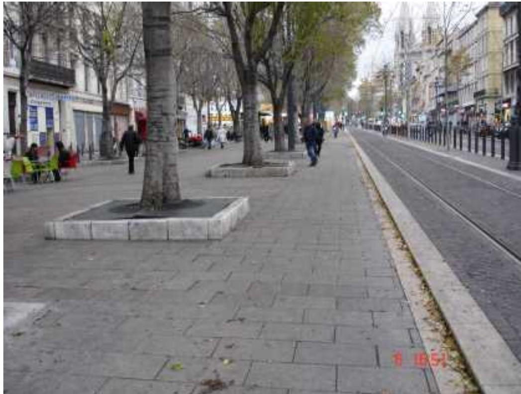
Margelle en granit clair, avec caniveau mono-pente intégré
