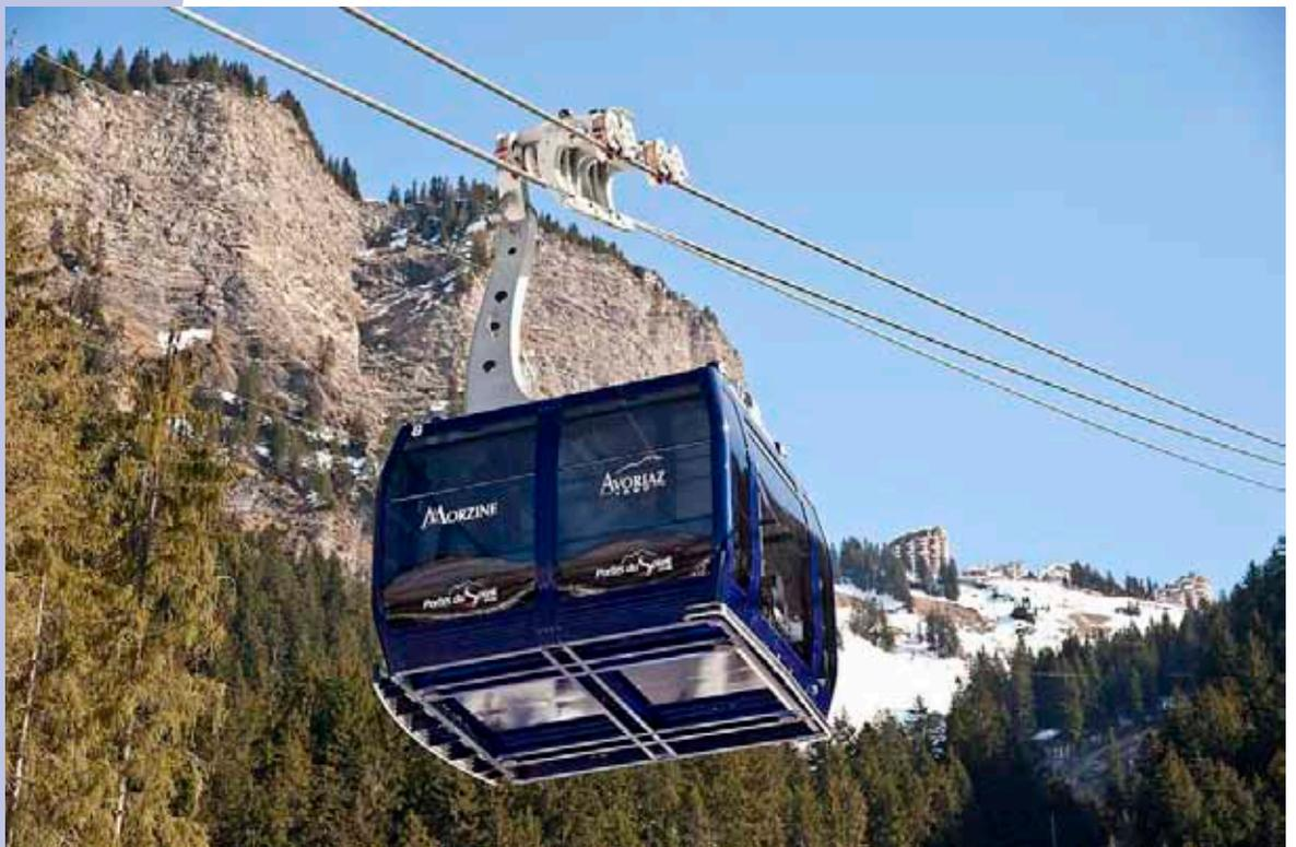
*\* la récupération intégrée vise à définir des dispositions constructives permettant de garantir la capacité de mouvoir le câble tracteur et les deux véhicules de l'installation, et ainsi de rapatrier les passagers en gare dans leurs véhicules en toutes circonstances.*
