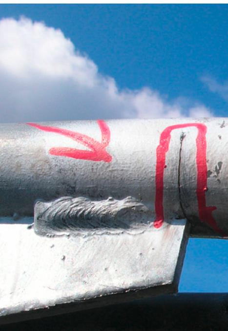
En février 2014, une rupture s'est produite en exploitation sur l'arceau d'un siège 3 places de type arceau plan POMA. Cet accident est intervenu après une quasi rupture relevée en 2008, en exploitation également, sur un autre TSF3 utilisant des sièges identiques. Il s'agit d'un problème de fissuration d'arceau en partie haute, à l'extrémité du gousset de renfort.
