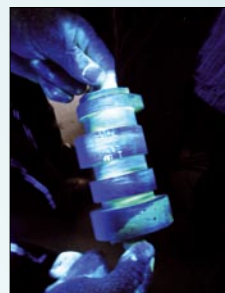
Contrôle par ressage sous UV.
