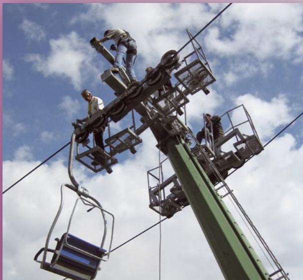
Essais de balanciers sur un télésiège à attaches fixes : une équipe du STRMTG en action.
