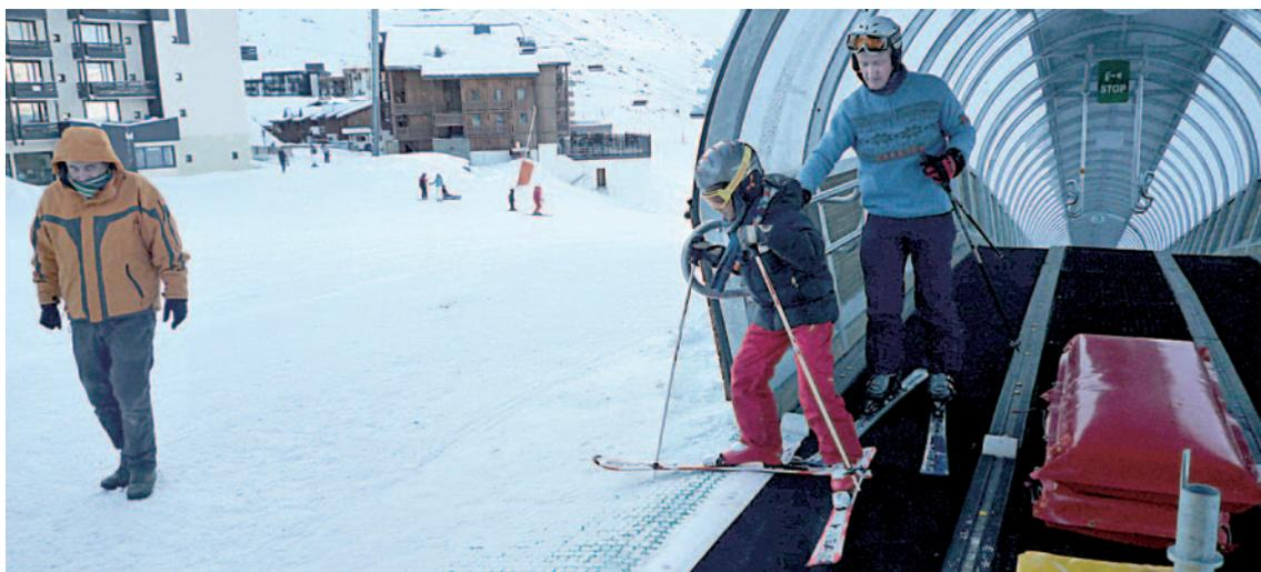
Pour garantir un niveau de sécurité comparable aux tapis ne dépassant pas 0,7 m/s, les constructeurs ont présenté au STRMTG une analyse de sécurité portant sur les risques associés à la vitesse de 1,20 m/s et les mesures correspondantes pour y faire face.
