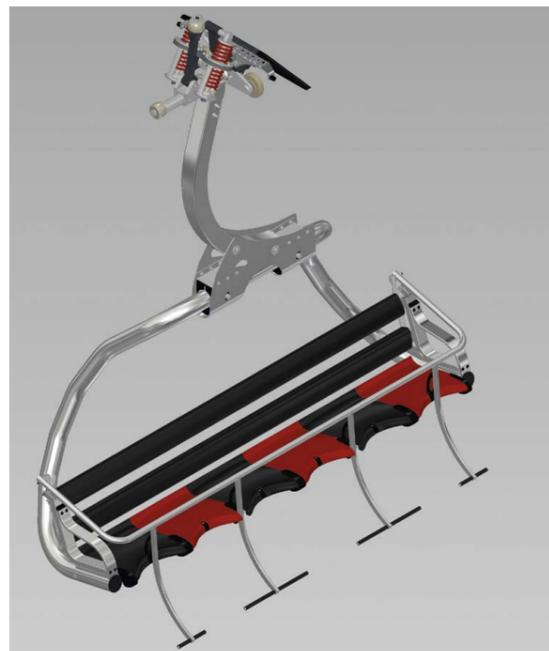
> Modèle de siège du télésiège du constructeur LST
