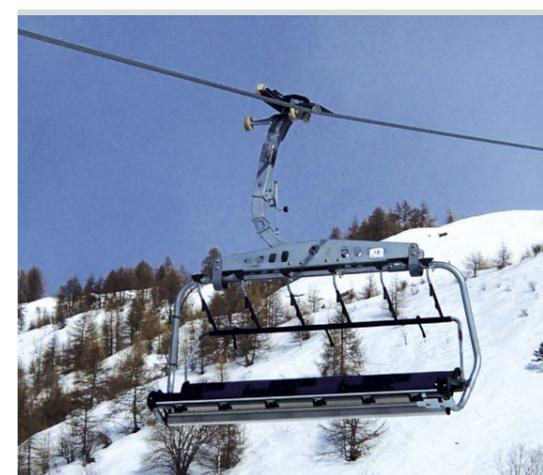
> Câble de remontée mécanique sur un téléski débrayable
