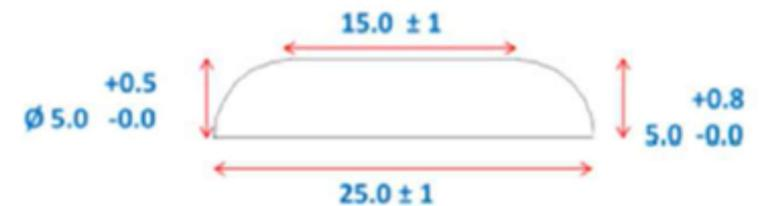
Figure 4 : Détail d'un plot
