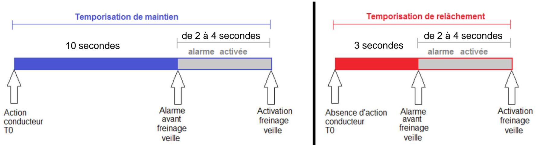
Augmenter la durée de l'alarme sonore en passant de 2 secondes à 4 secondes.
