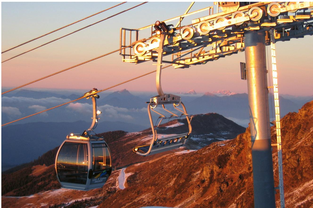
véhicule pour les cabines. La vitesse peut parfois être différenciée : l'embarquement et le débarquement des cabines aux alentours de 0,3m/s et de l'ordre de 1m/s pour les sièges. Pour des questions de coût, les sièges représentent souvent les 3/4 des véhicules, parfois plus.
