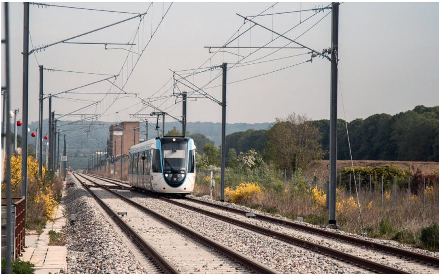
Le matériel roulant est de type tram-train, de la gamme Dualis d'Alstom. Il mesure 42 mètres de longueur et 2,66 de large. 11 véhicules exploités en unités simples ont été livrés dans un premier temps.
