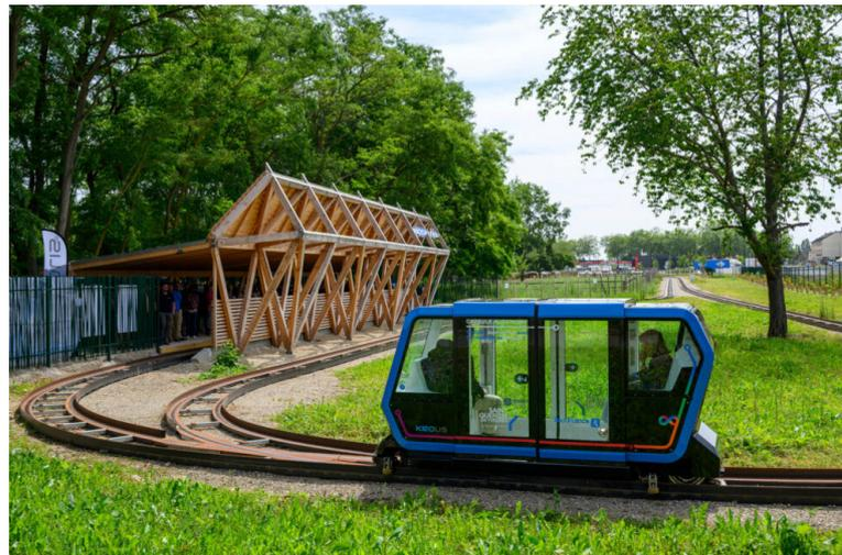
Il n'y a pas d'aiguillage au sol, le système de sélection de la direction est porté par la capsule elle-même, ce qui permet d'augmenter la fluidité des circulations.
