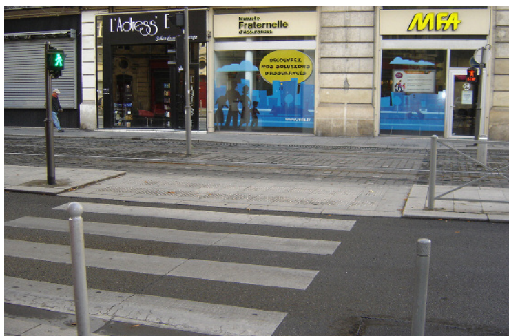
Traversée en plusieurs temps : les signalisations lumineuses des voies routières et de la plateforme sont dissociées, avec recours au R25 dans l'exemple ci-contre
